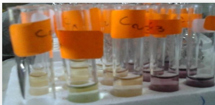
Figure 30 : Décoloration de la solution du DPPH du violet en jaune en fonction de la concentration.
