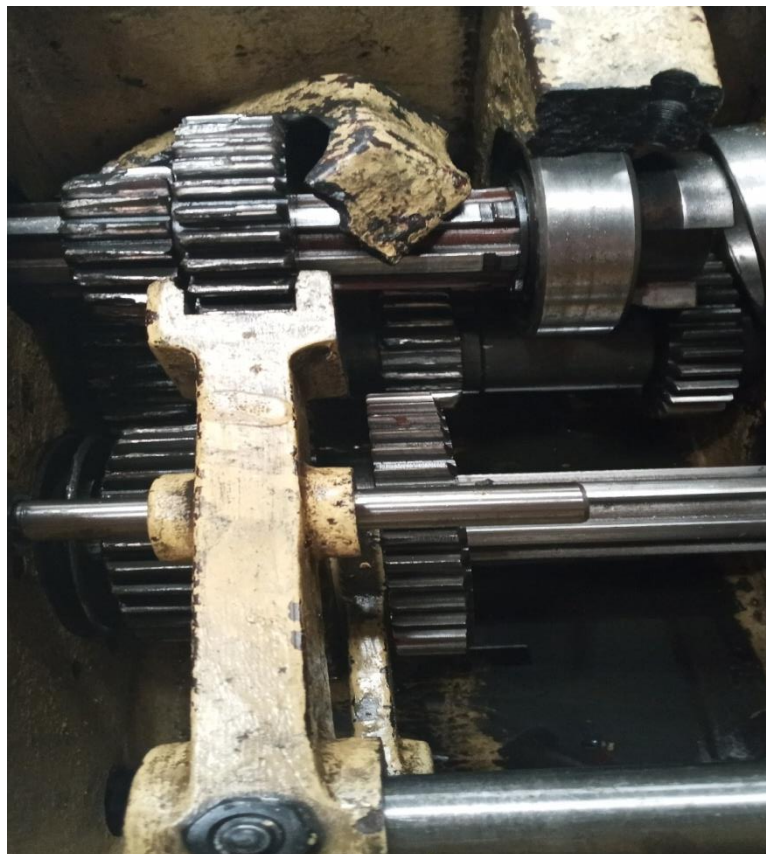
Figure .II.2. boîte de vitesse d'une machine de tournage
