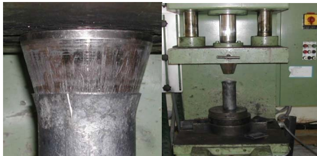
Figure I.22. Tube évasé et Machine d'évasement [12].
