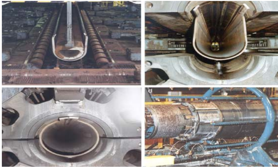
Figure I.8. Formage en U, formage en O, et soudage de la fabrication des tubes soudés en long [4].
