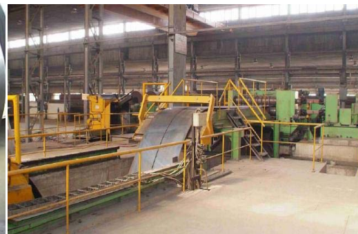
Figure I.5. Déroulement des bobines
