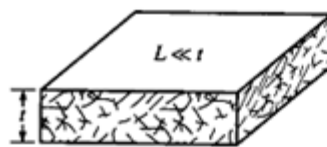
(a) Orientation aléatoire en 3D lorsque la longueur des fibres est plus faible que l'épaisseur de la pièce
