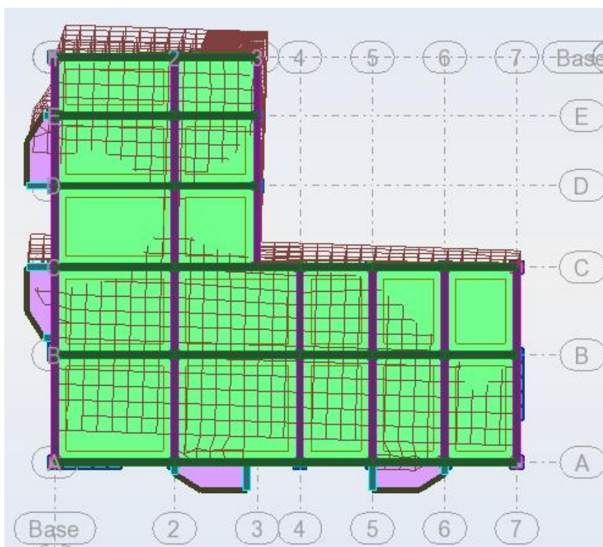
Fig.IV.4 : Premier mode de vibration. vue en plan (T1= 0,47 s )
