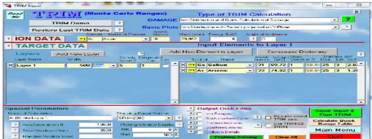
FigureII.4 : Tableau de bord pour le bombardement ionique des ions Ar^+ dans le GaAs
