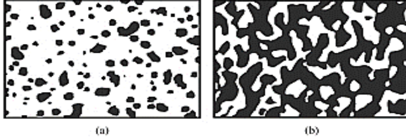
Figure I.51 : Matériau FGM à deux phases présentant (a) une microstructure particulaire et (b) une microstructure squelettique [39]
