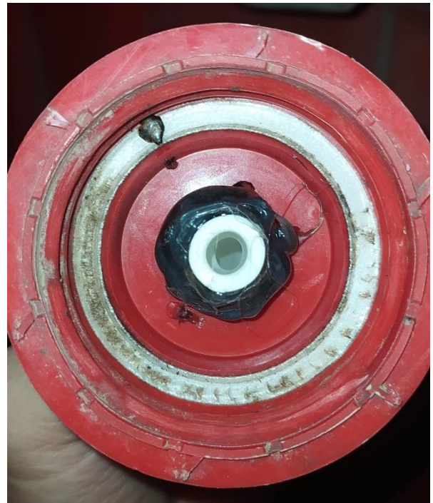
Figure 22 : Le joint entre le tube et le bouchon
