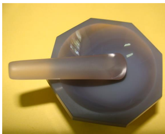
Mortier pour broyage Poudre+KBr
