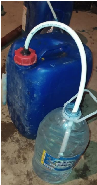
Figure 24: les récipients de fermentation remplies et assemblées
