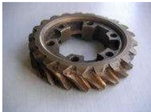
Figure 2.16 Dégradation des dents d'une roue dentée
