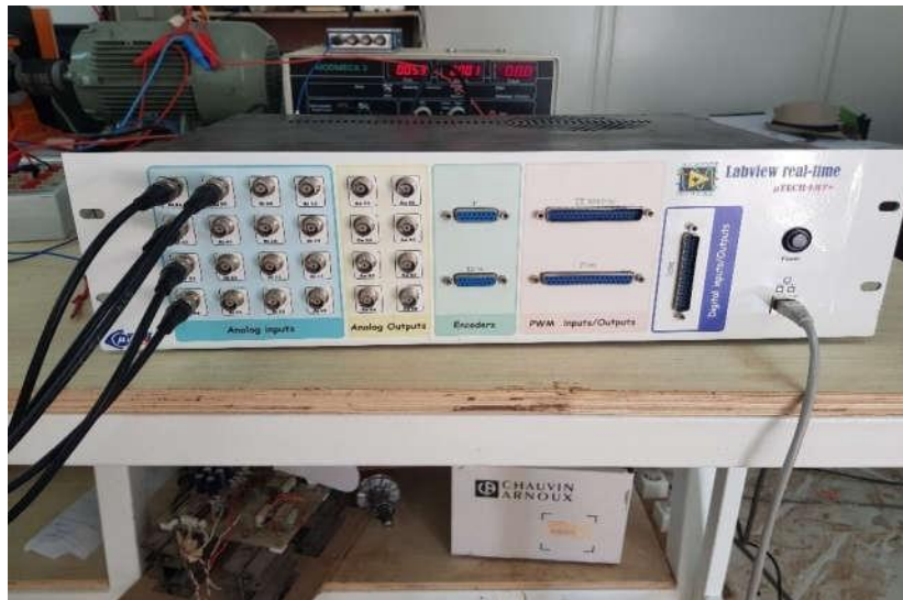
Figure.4.10 : La Plateforme temps réel programmable \mu TECH-LRT+ de NI
