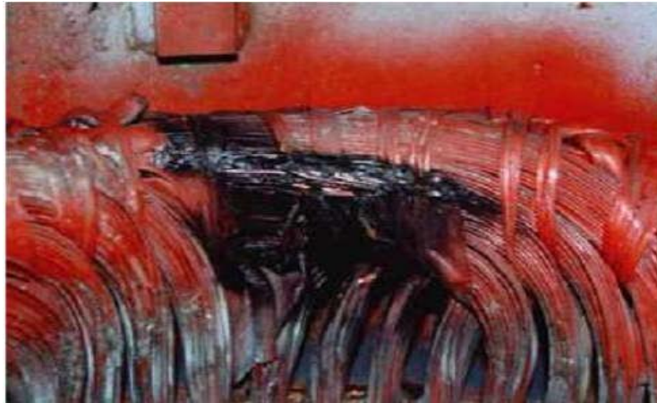
Figure 2.3 Court-circuit dans les enroulements statoriques
