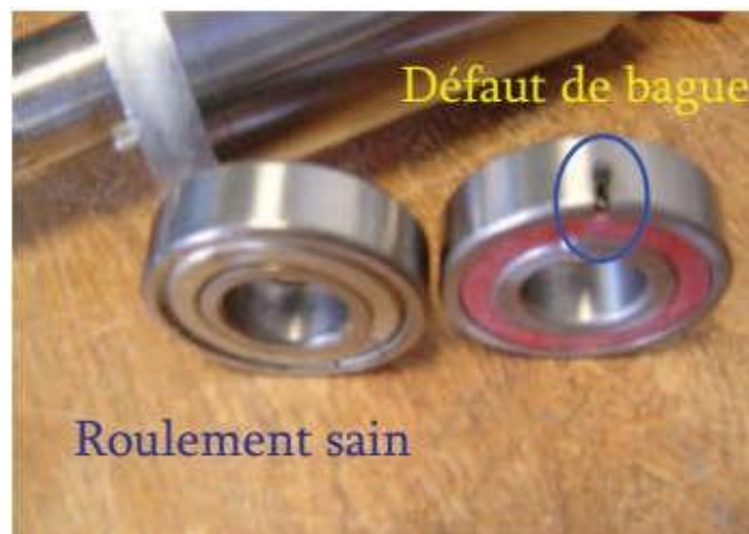
Figure. 4.39 : Vue des roulements sains et défectueux (bague cassée)
