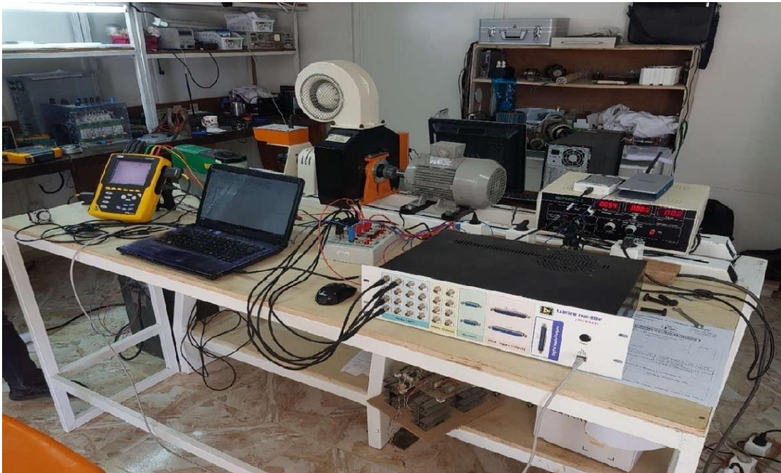
Figure. 4.1: Banc d'essais d'une machine asynchrone au niveau de la DEDINE (CRNB)
