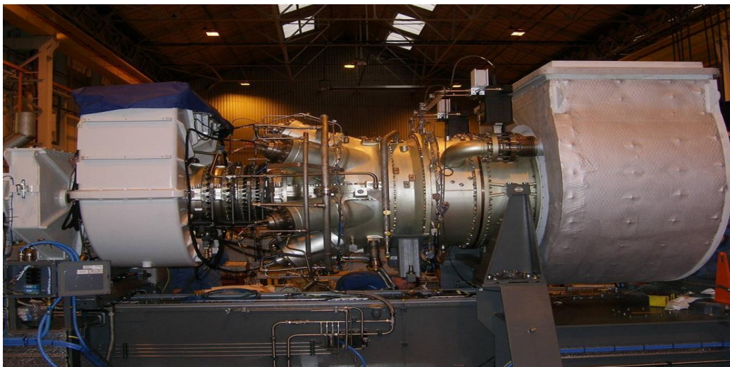
Figure I.6 : Turbine à gaz SGT-400
