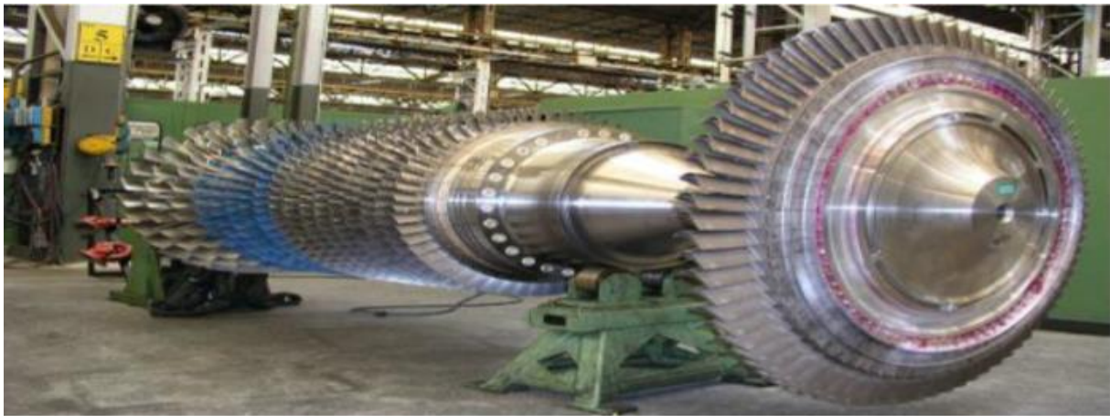
Figure I.9 : Ensemble rotor compresseur /roue turbine HP.
