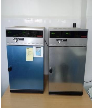
Etuve universelle de 5 à 220°C avec ventilation (MEMMERT).
