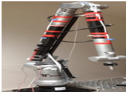
Figure I.4: Photo du Bras SIGMA 2025 instrumenté.
