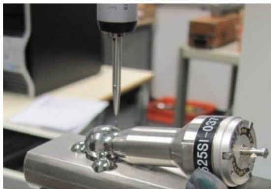
Figure II .2 : Photo de l'étude de la stabilité de prise d'un point sur MMT
