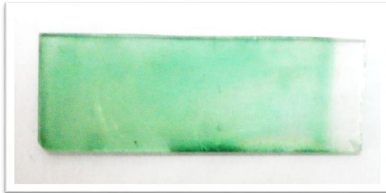
Figure II.3: Photos montrant des couches minces de Zn_{1-x}Co_xO déposées sur substrat de verre par la technique USP. [1].
