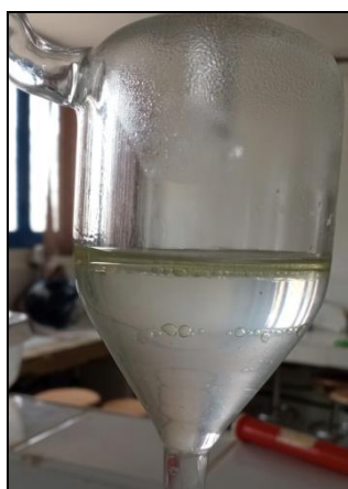
Figure 19 : Photographie montrant la séparation des HsE par décantation.
