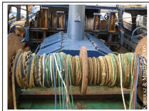
Fig. 5 : Treuil à bord d'un chalutier.
