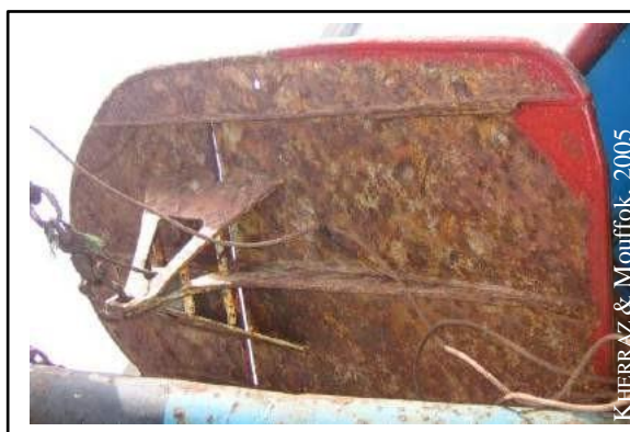
Fig. 1 : Panneau de fond du type méditerranéen (120 à 150 kg) adapté aux navires de 180 à 400 CV (PRADO, 1988).
