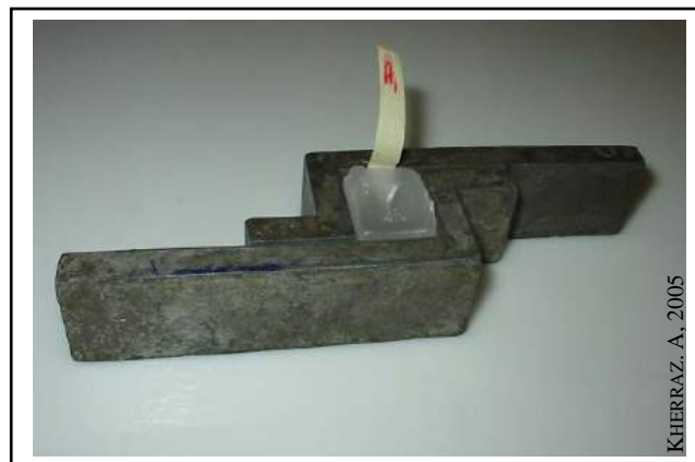
Fig.1 : Un bloc de paraffine formé entre deux barres de LEUCKART.
