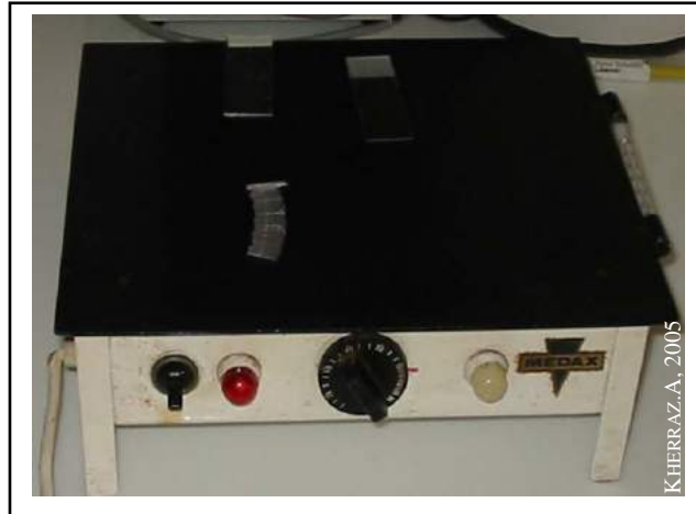
Fig. 4: Etalement d'une coupe à la paraffine sur une platine chauffante.
