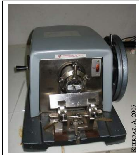
Fig.2 : Microtome de Minot pour la confection de lames histologiques.
