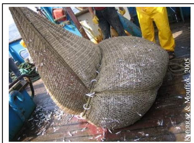
Fig. 7 : Arrivée du cul de chalut sur la passerelle du chalutier.
