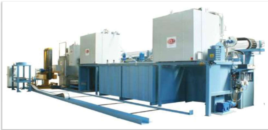
Figure II.4: chaine de traitement thermique SOLO.
