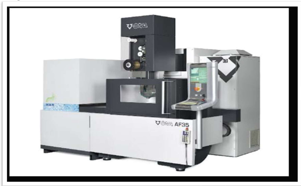
Figure II.5 : Machine de fil coupant ONA et échantillon secondaire
