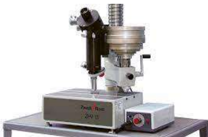
Figure II.11 : Appareil de Micro- dureté Zwick Roell, modèle : ZHV10.
