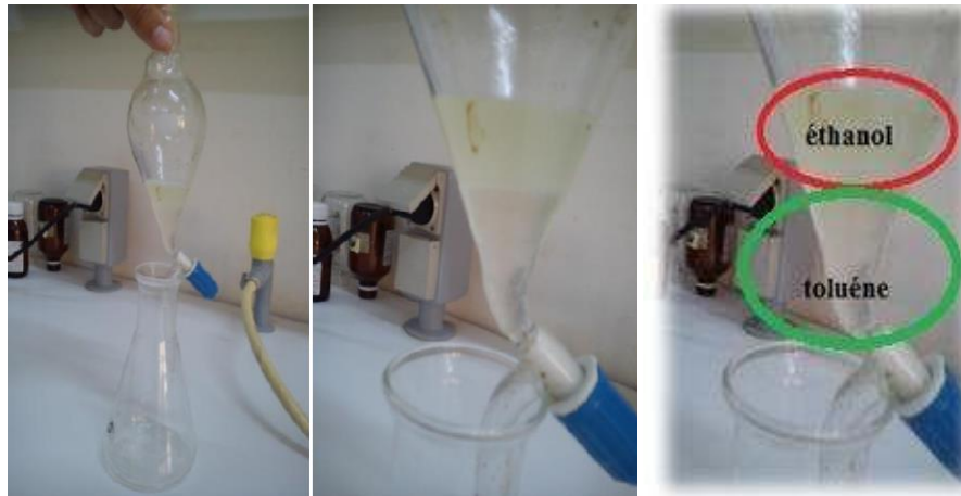
Figure 15: la décantation du mélange azéotrope par l'ampoule à décanté (original)
