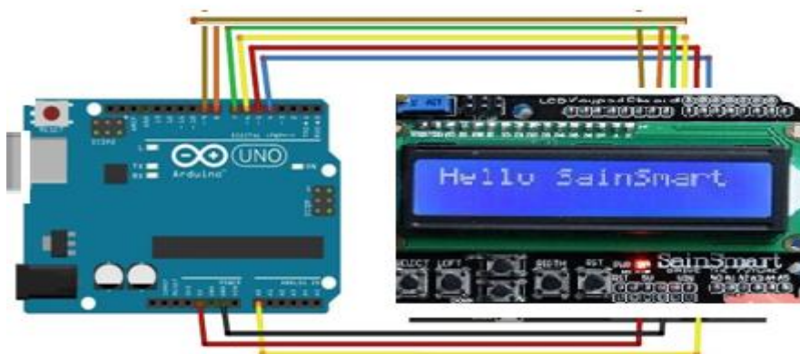
Figure IV.8 : Brochage LCD Keypad avec UNO
