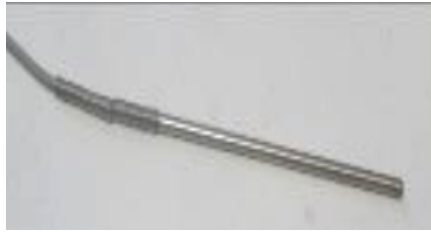
FIGURE I.11 – Les capteurs de température à résistance.
