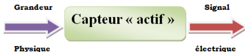
FIGURE I.4 – Principe du capteur actif.
