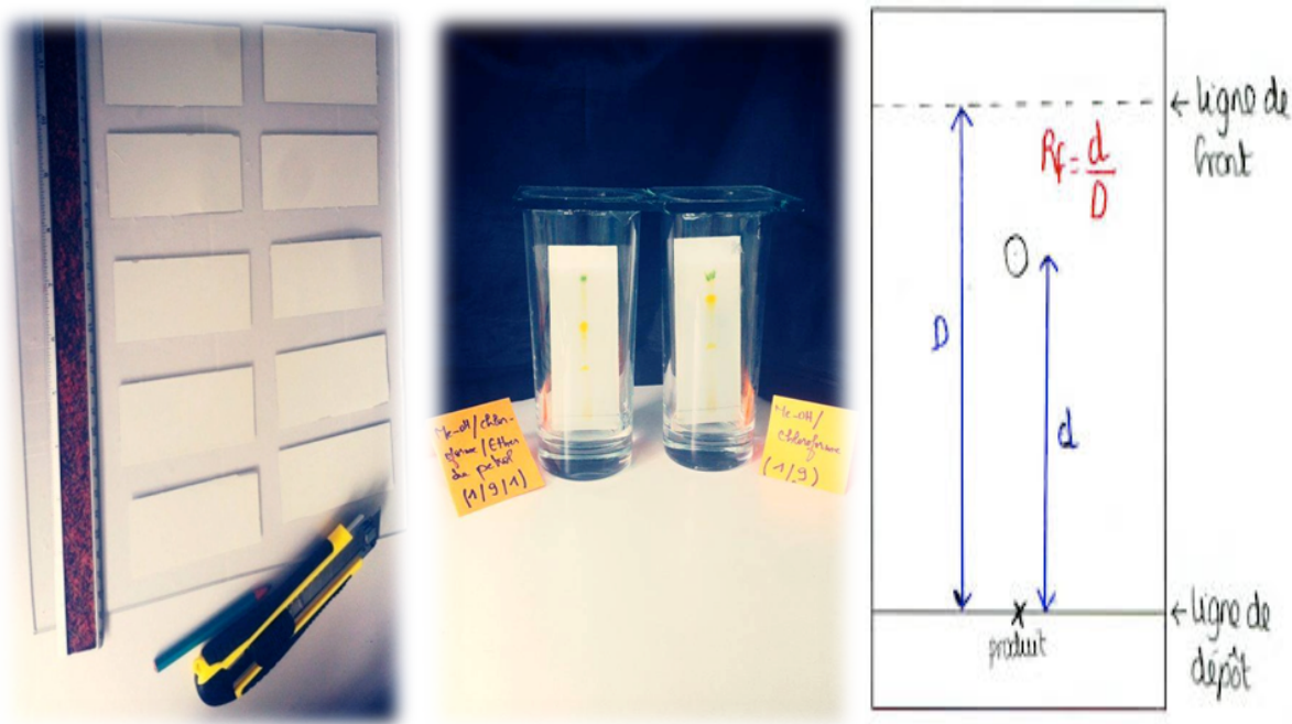
Figure 16: Méthode de préparation de la CCM
