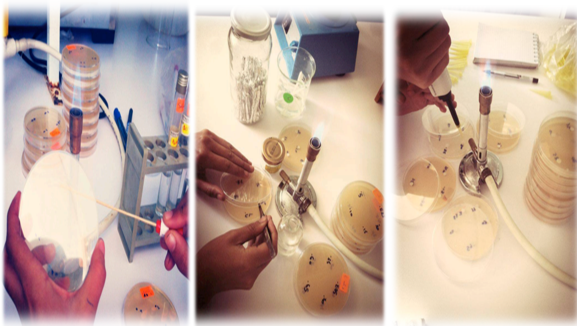
Figure 11 : Méthode de diffusion à partir d'un disque solide
