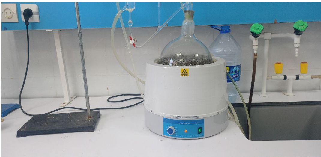
Figure 2 : Dispositif d'hydrodistillation Clevenger. (Photo personnelle)
