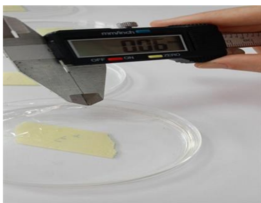
Figure 3: Mesure de l'épaisseur des films à base de gélatine à l'aide d'un pied à coulisse numérique. (photos personnelles)
