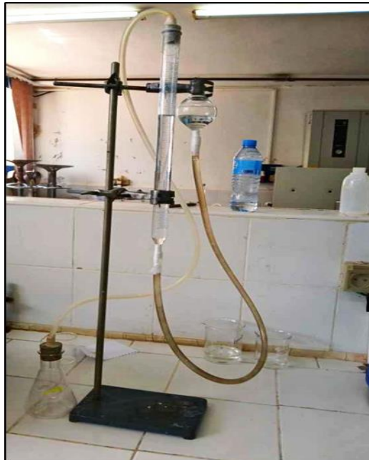
Figure 15 : Calcimètre de brand(photooriginale2024).
