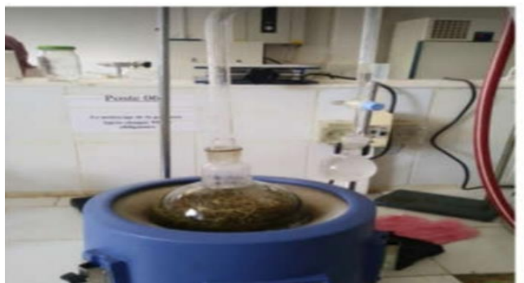
Figure 18 : Montage de l'extraction par hydrodistillation (photo originale 2024).
