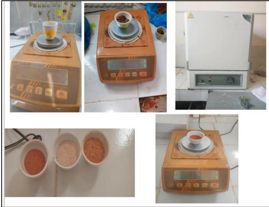
Figure 13 : Les étapes pour déterminer la matière organique de sols.
