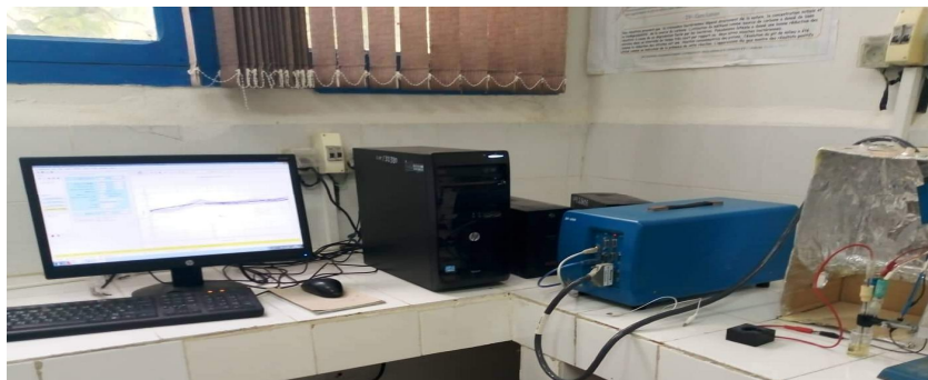
Figure III.4 : Représentation schématique du dispositif expérimental utilisé pour l'élaboration d'un capteur électrochimique pour la détection d'acide urique.
