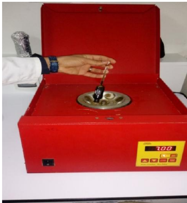
Figure 04 : Centrifugeuse «Funk-Gerber» de séparation de la matière grasse de la crème dessert caramel.
