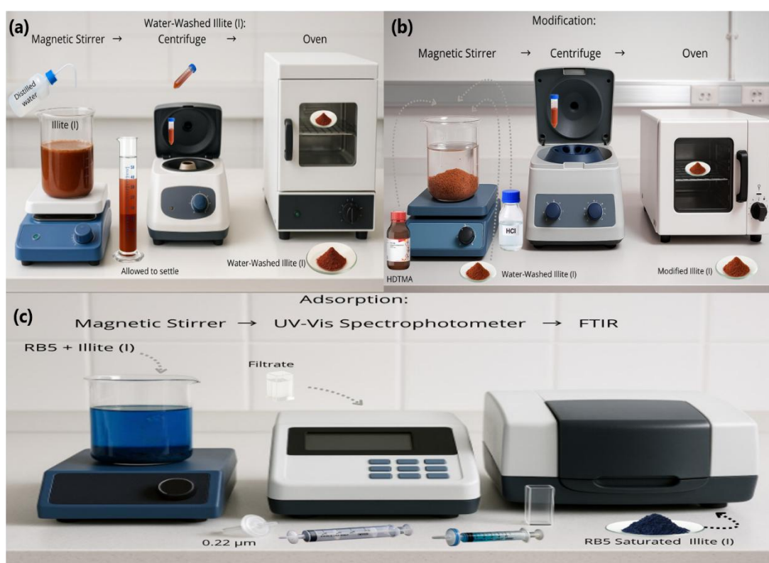
Figure IV.62: Schéma du protocole expérimental appliqué à l'étude de l'adsorption du RB5 par les argiles illitiques.
