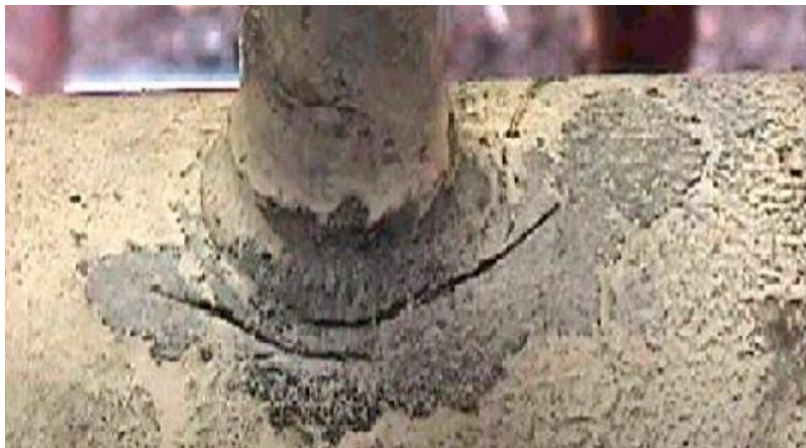
Figure III.10. : la Corrosion par fatigue
