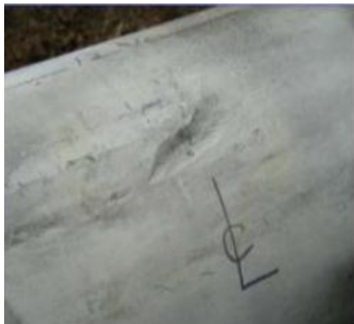
Figure III.4: Dommages mécaniques (éraflure)
