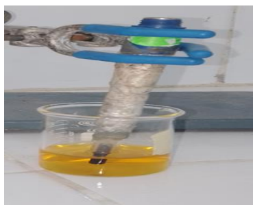
Figure.III.20 : électrode ECV/PAni émergée dans solution de FeCl_3 ( 5 \times 10^{-2} M ).
