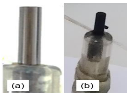
Figure.III.19: images photographiques a) ECV nue, b) sel d'émeraldine formé suite à la polymérisation électrochimique d'aniline.
