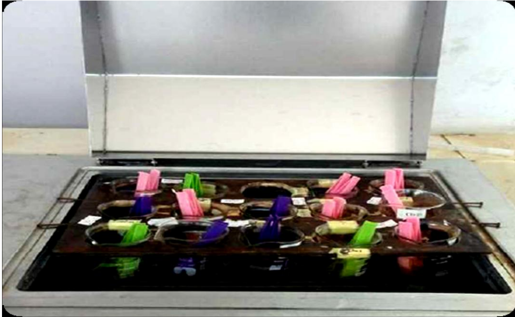
Figure III.4 : Dispositif expérimental de la méthode de la masse perdue.
