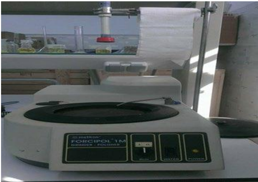
Figure III.1: Photo d'une polisseuse utilisée dans le polissage mécanique.
