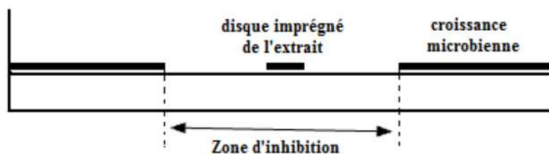
Figure 17: Aromatoگرامme sur boîte de pétri à diffusion linéaire à partir d'un disque imprégné de l'extrait végétale.
