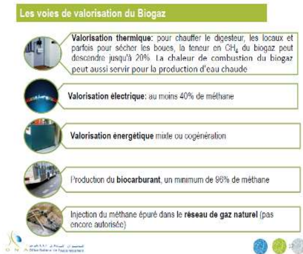
Figure III.7 : Différentes voies de valorisation du biogaz
