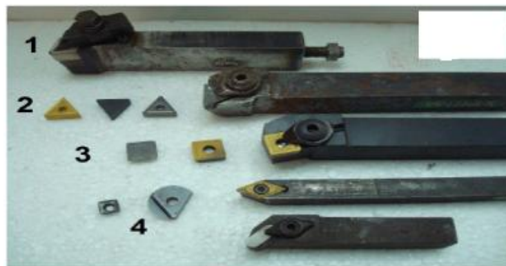
Figure I-29. Outil de coupe à plaquette rapportée [20].
