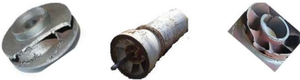
Fig. II. 12 : Dégâts de Cavitation sur les éléments d'une pompe centrifuge.
