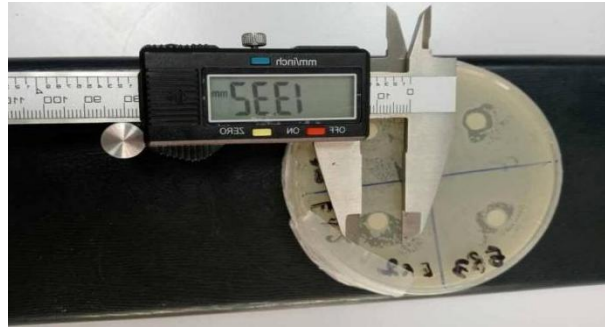
Figure 21: Mesure de diamètres des zones d'inhibition par Pied à coulisse (Photo personnelle).
