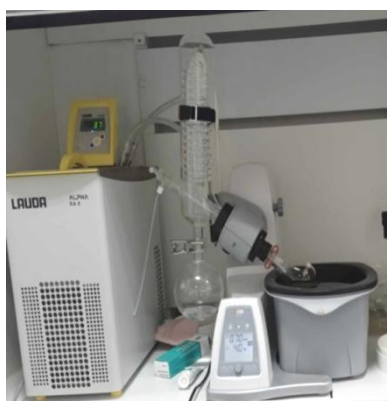
Évaporation dans un évaporateur rotatif sous pression réduite à 40 °C
