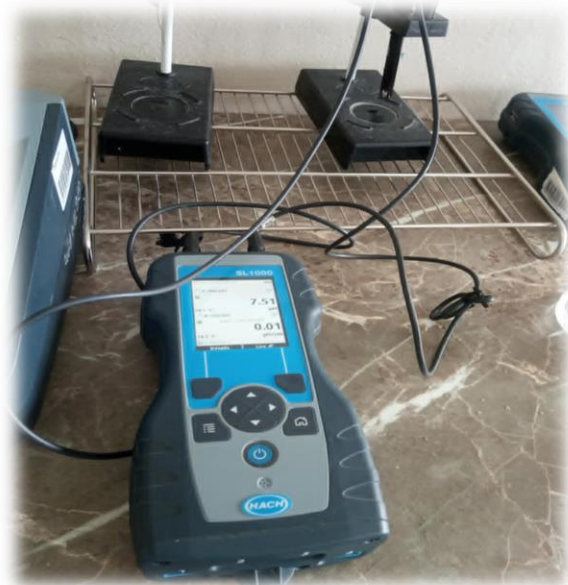
Photographie 01 : Appareil de Mesure la conductivité (multi paramètre).
