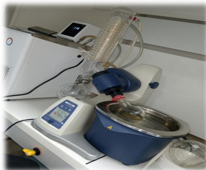
Photographie 07: Appareil de rotavap pour récupération d'extrait d'échantillon.
