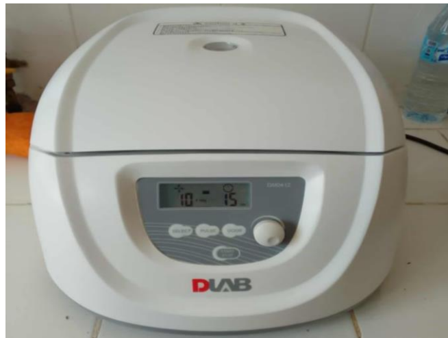
Photographie 05: Photo de Centrifugeuse (10 000 rpm pendant 15 minutes).
