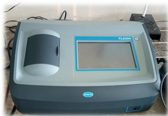
Photographie 02: Appareil de Mesure la turbidité (Turbidimètre).
