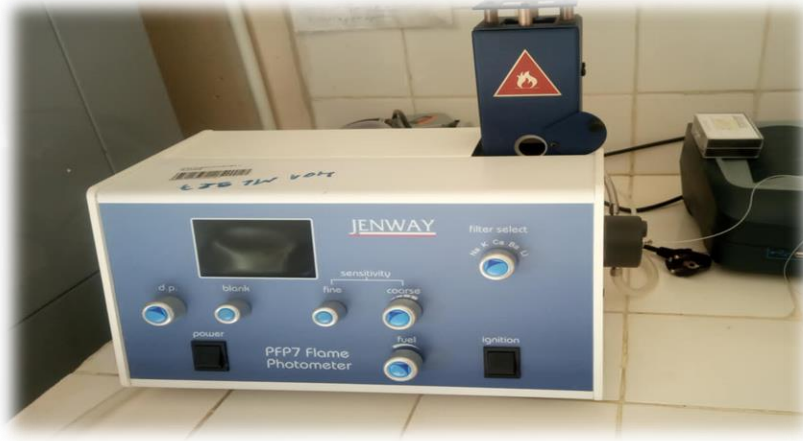
Photographie 04 : Appareil de Mesure potassium et sodium (spectrophotomètre à flamme).
