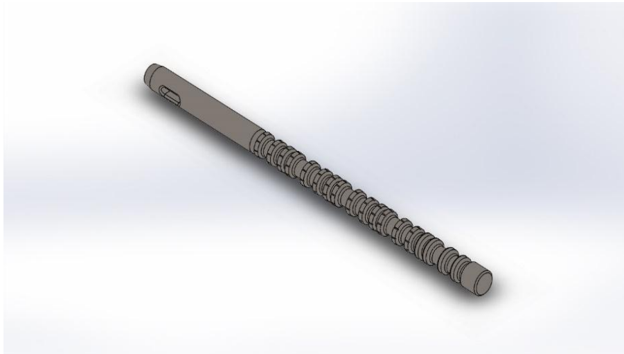
Fig. III.35. Broche réalisée par SOLIDWORKS.
