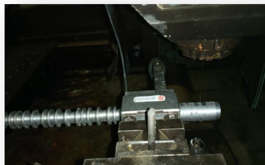
Fig. III.29. Positionnement de la pièce sur machine d'électro-érosion.
