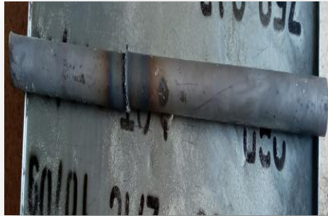
Fig. III.6. Soudage en bout de deux morceaux.
