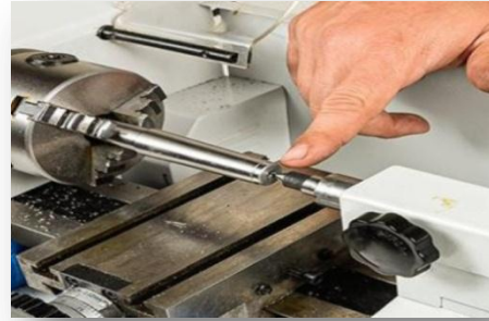
Fig. I.8.b). Opération de centrage.
