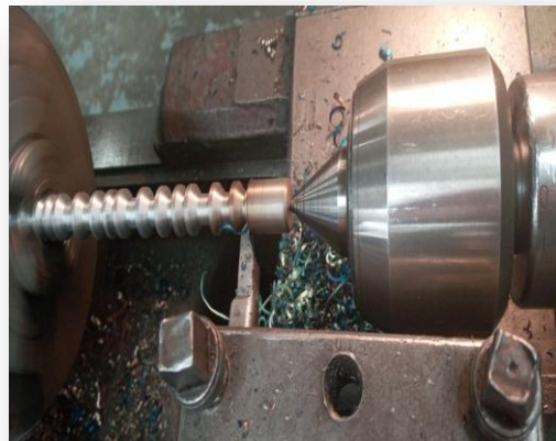
Fig. III.12. Schéma de réalisation des dents de la pièce.
