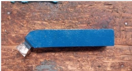
Fig. III.14. Outil à dresser et charioter.
