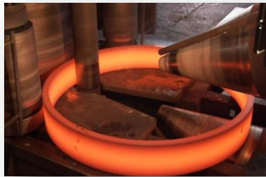
Fig. I.31. Forgeage par laminage circulaire.
