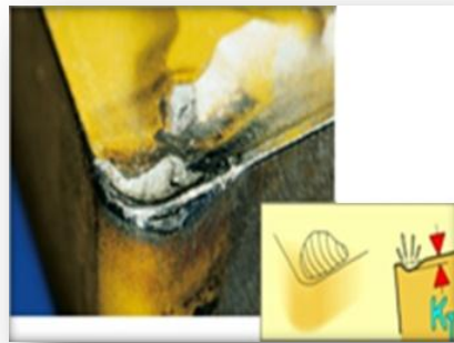
Fig. II.9. Usure en cratère (chimique).
