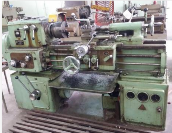
Fig. III.13. Tour universel modèle AI616 fabriqué en URSS.
