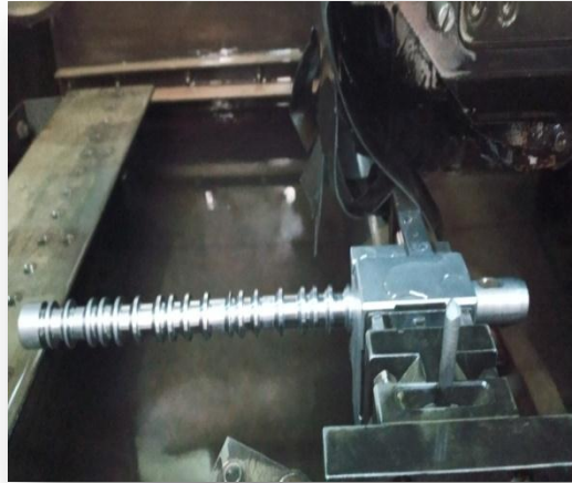
Fig. III.17. Réalisation des dents sur tour à CN.
