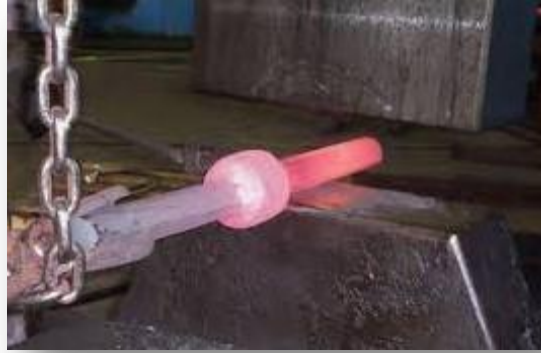
Fig. I.30. Exemple de forgeage libre.
