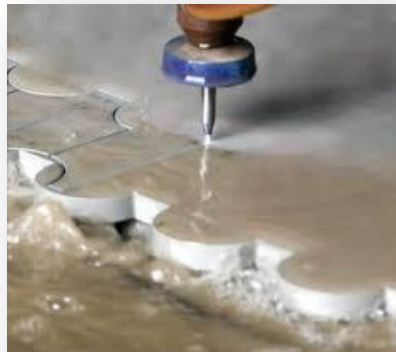
Fig. I.52. Principe de jet d'eau.
