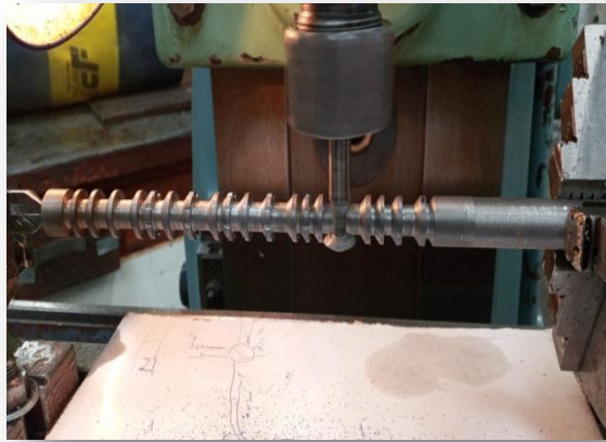
Fig. III.20. Fraisage de brise-copeaux.
