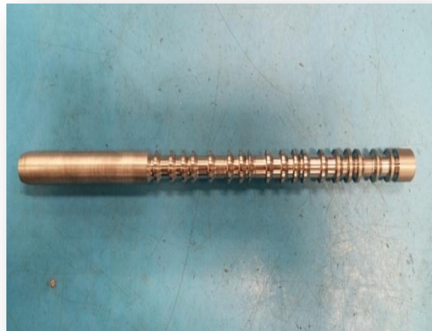
Fig. III.18. Dents obtenus après usinage à CNC.
