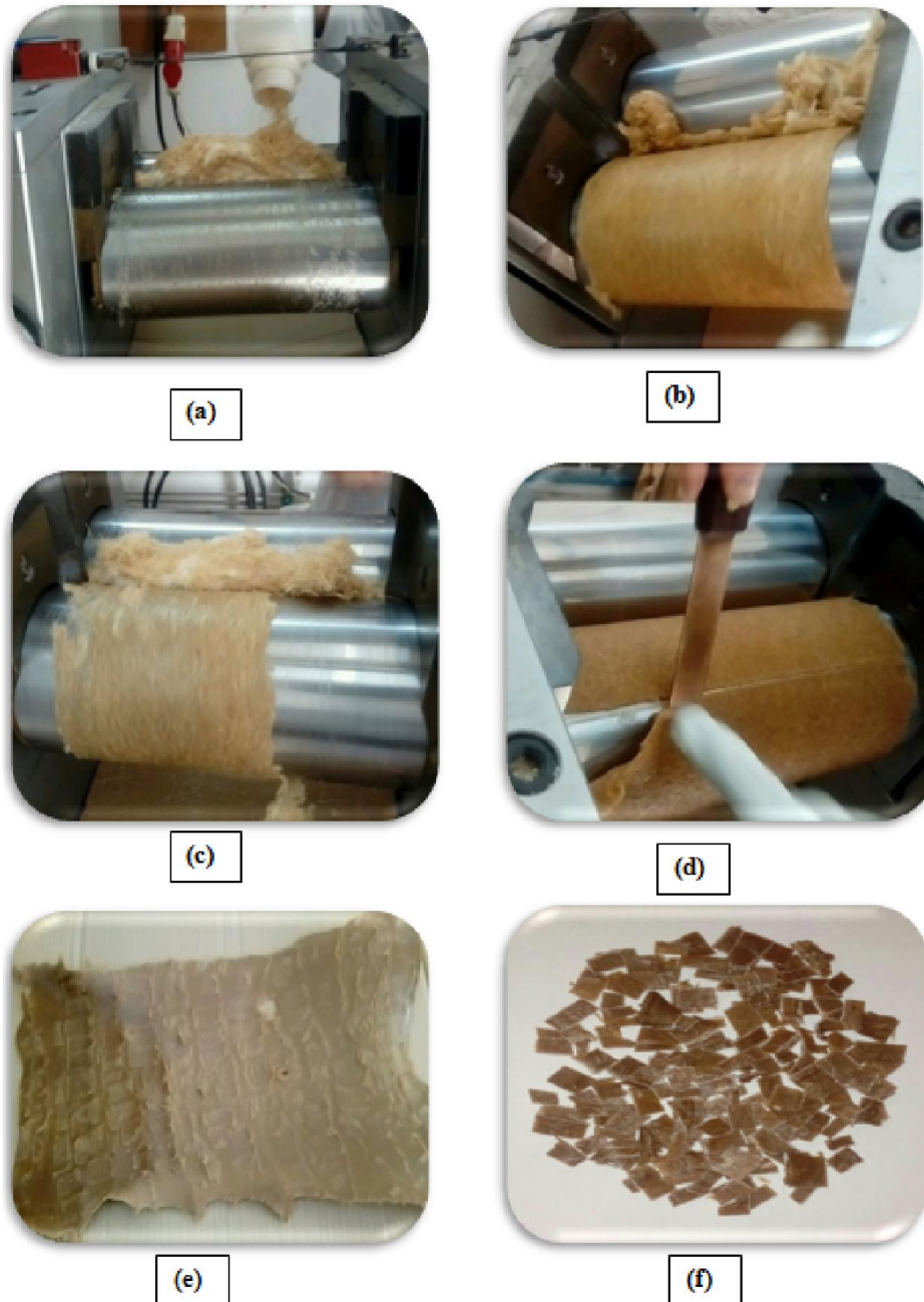
Figure III.3: méthode d'élaboration des plaques bio composites entre les deux cylindres.
