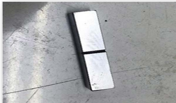
Figure II.25. Géométrie des éprouvettes de résilience
