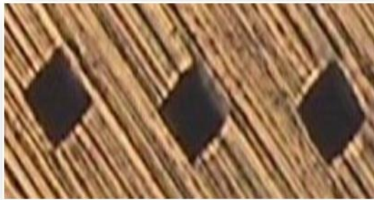
Figure III.10. Les empreintes superficielles d'indentation de l'acier 42CrMo4 avant la nitruration
