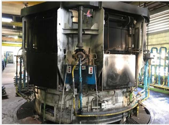
FigureII.9. Four électrique de revenu (ETRAG-Constantine)
