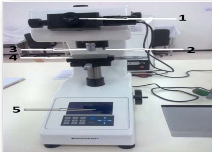
Figure II.20. microduromètre Innovatest. 1) caméra CCD 2) indenteur 3) objectif microscopique 4) platine porte-échantillon 5) écran de visualisation de l'empreinte [26].
