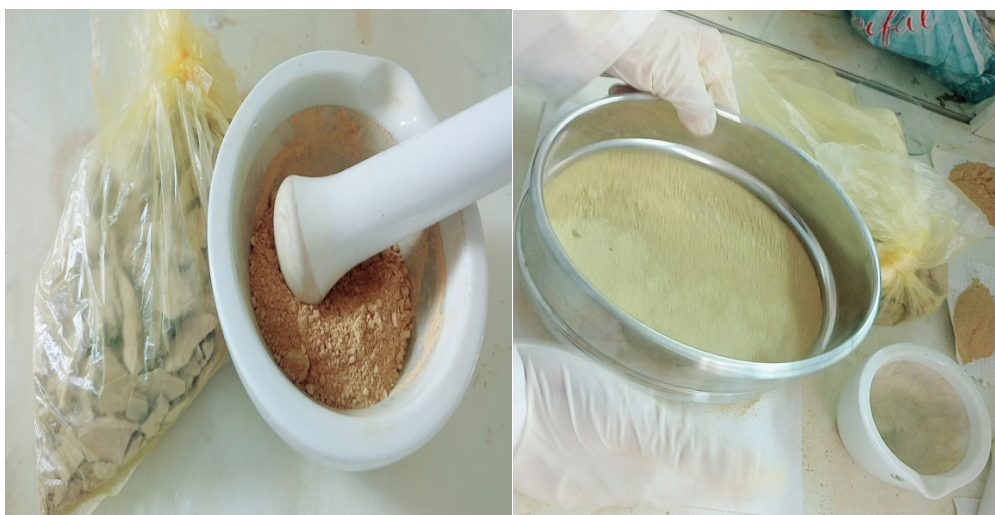
Figure IV.1 : Argile a) broyée b) Tamisé.
