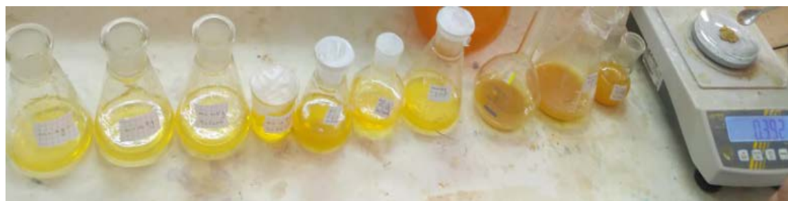
Figure IV.10 : 50 ml de solution \text{FeCl}_3 avec différentes masses d'argile intercalée.
