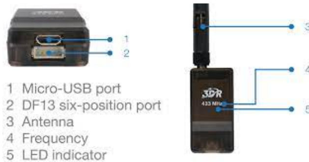
Figure 4.5: Explication des différentes entres de radios de télémétrie 3DR
