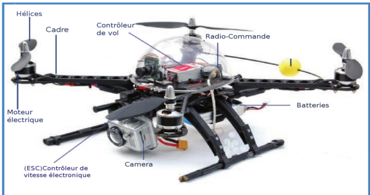
Figure 1.2: Les composants d'un Quadri-rotor
