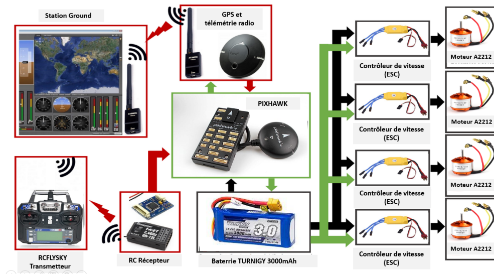
Figure 4.7: Le montage de Pixhawk avec les autres composants
