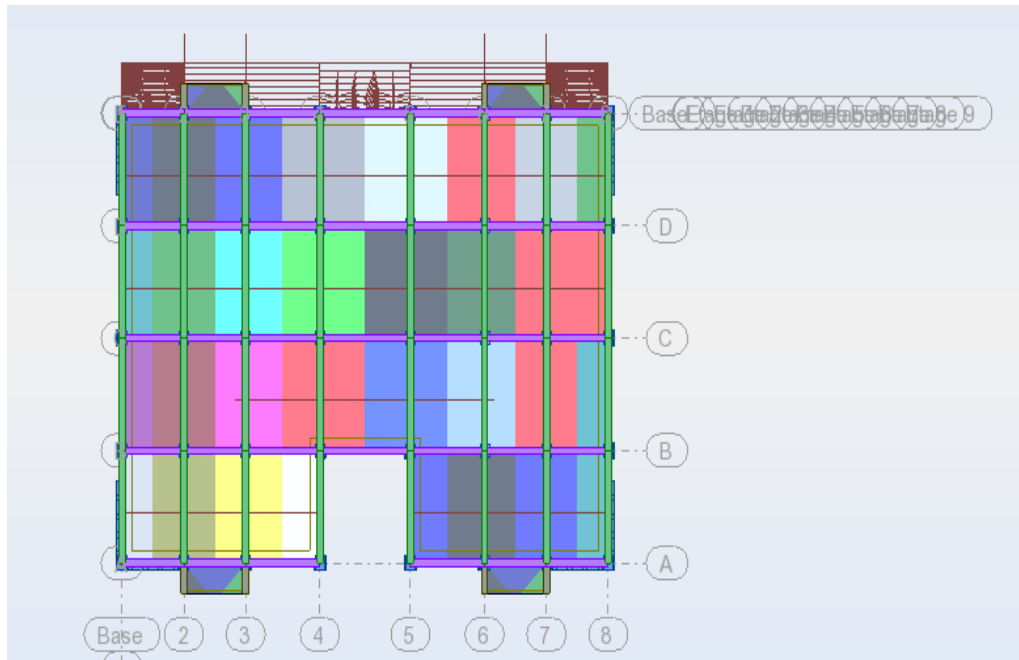
Fig-IV-3 : Premier mode de vibration. vue en plan ( T_1= 0,66 s )
