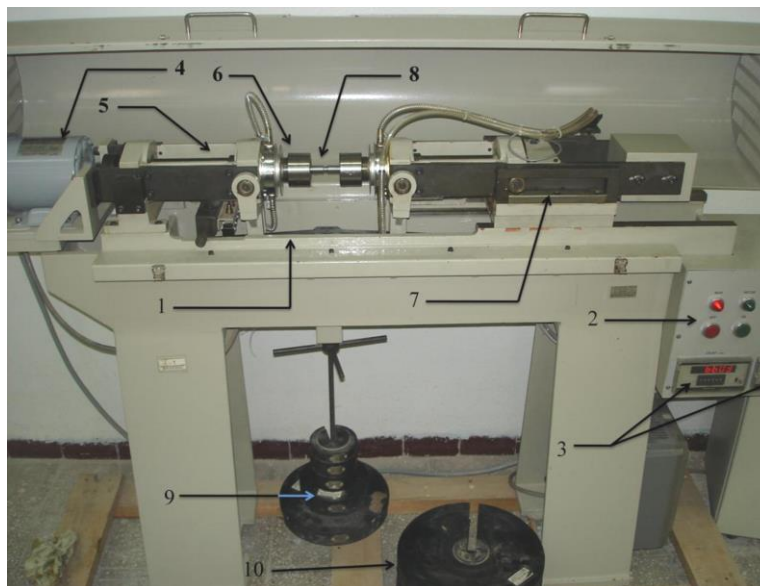
Figure I.21: La machine d'essai de fatigue en flexion rotative
