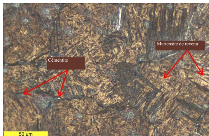
Figure IV.8 : Microstructure de la couche d'éprouvettes superficielle des éprouvettes cimentées a l'état final
