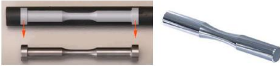
Figure I.22 : Eprouvette en acier de structure et toroïdale pour essai de fatigue
