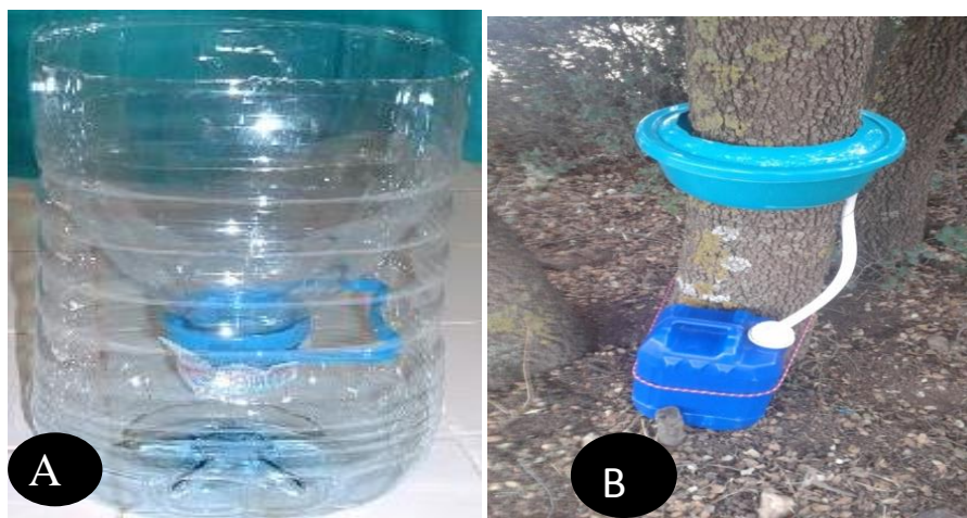
Fig. 11: Dispositif de récupération des eaux de précipitations, égouttement(A) et écoulement(B).
