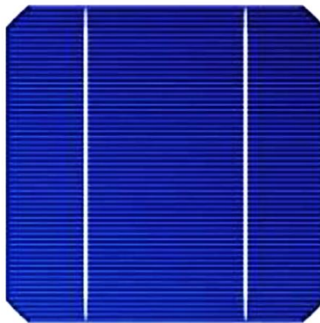
Figure I.8 : Cellule photovoltaïque à base de silicium monocristallin [12].
