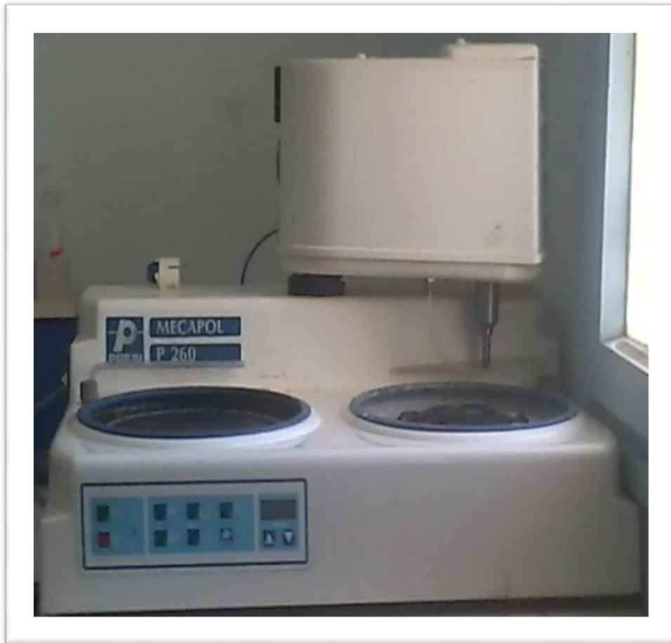
Fig.III.4. Schéma de polisseuse utilisé dans le polissage mécanique.
