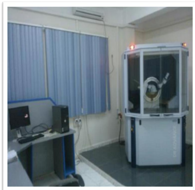
Fig. II.1.Appareillage de la Diffractomètre DRX [4].
