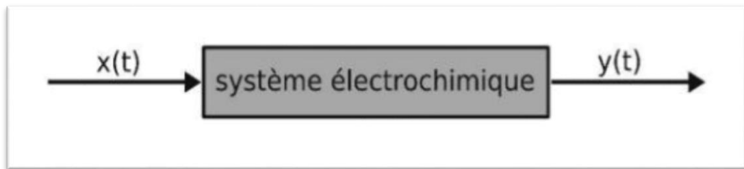
Fig. II.21: Principe de la spectroscopie d'impédance électrochimique [48].
