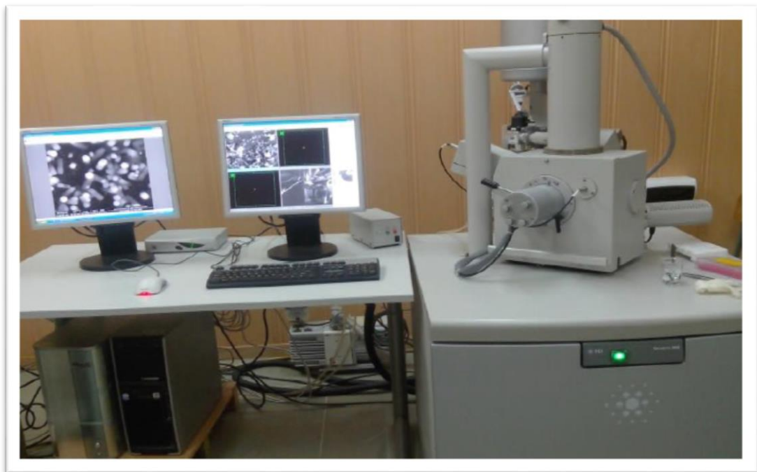
Fig. II.8. Microscopie électronique à balayage [14].
