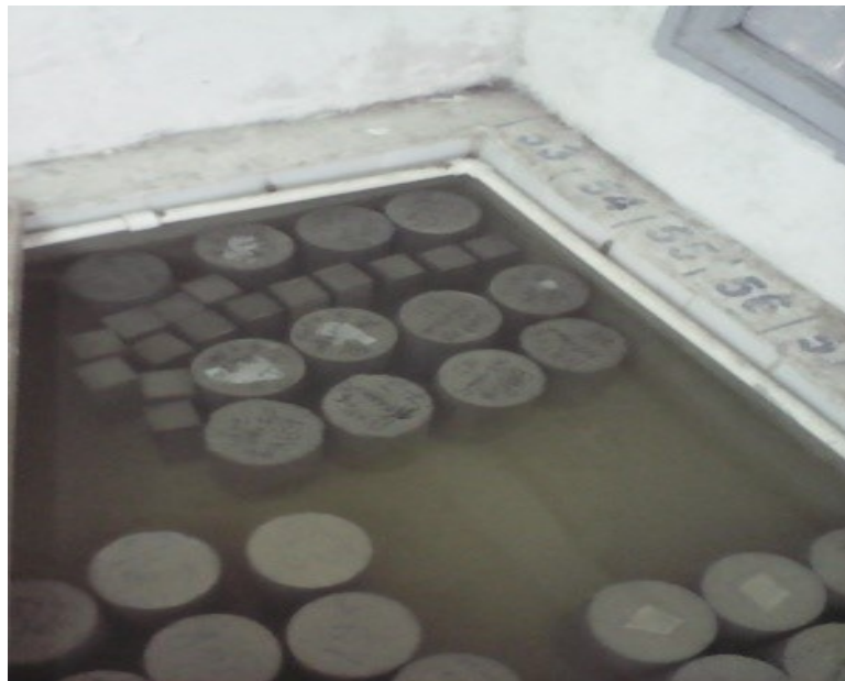
FIGURE III.8 — Conservation des épreuves dans un bac d'eau à une température ambiante.
