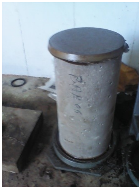
FIGURE III.12 — Après le surfaçage au soufre.
