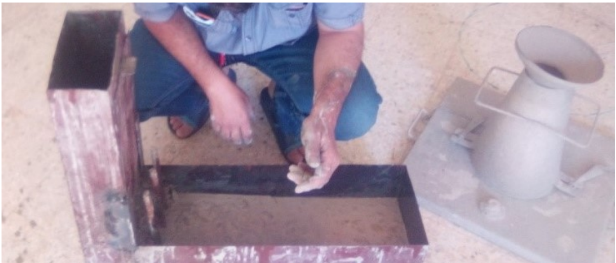
FIGURE I.7 — Essai de la boîte en L.
