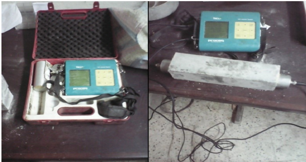
FIGURE III.5 — Essai d'auscultation sonore des bétons autoplaçants à 28jours.
