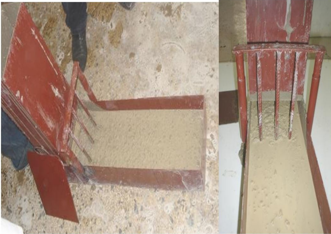
FIGURE I.4 — Aspect de l'essai de la boîte en L [2].
