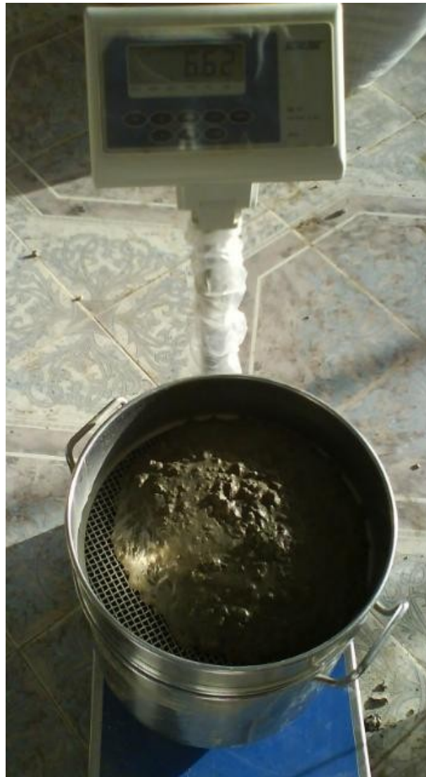
FIGURE I.5 — Aspect de l'essai de la stabilité au tamis [2].
