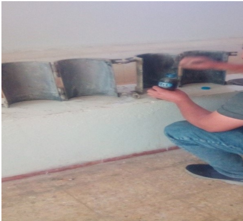
FIGURE III.6 — Préparation des éprouvettes cylindriques (16x32).
