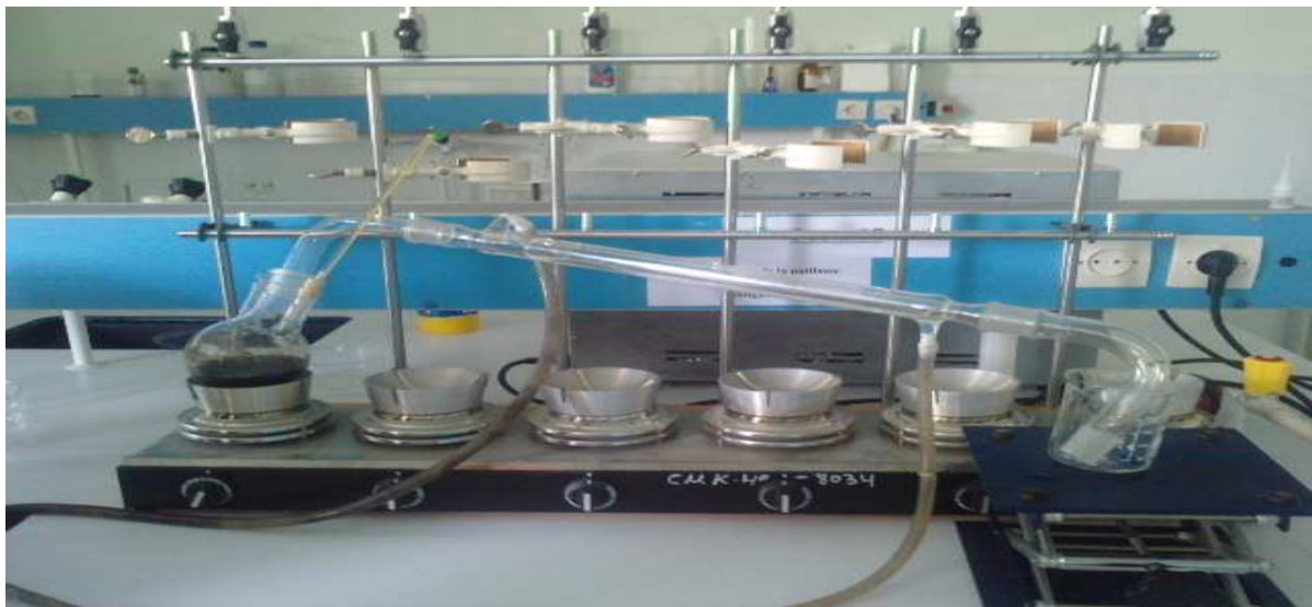
Figure (02) : Montage d'une hydrodistillation simple
