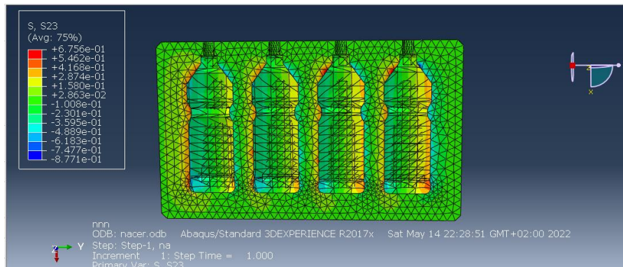
Figure III-13 : La concentration de la contrainte tangentielle \tau_{yz}
