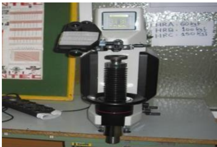
Figure III.21. Duromètre utilisé pour l'essai de dureté HRC (ECMK-Khenchela)
