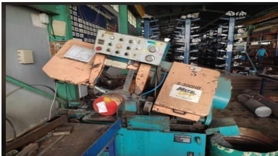
Figure III.4. l'opération de découpage ....(scies à ruban)
