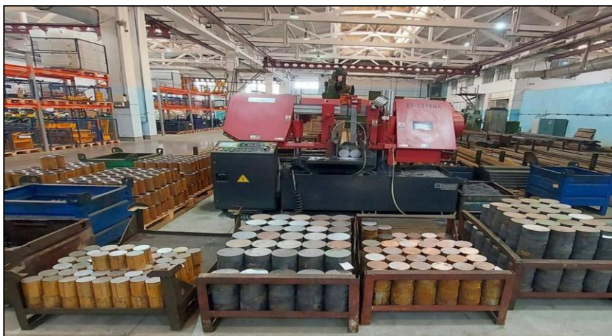
Figure III.3. Machine de découpage des barres métalliques par scie à ruban horizontale
