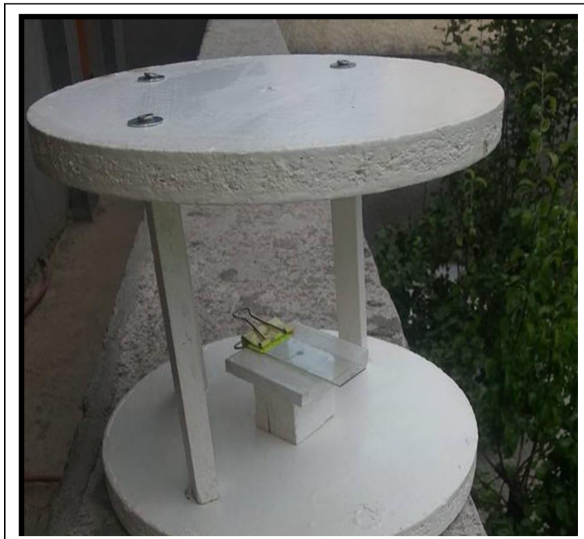
Figure 8. Photographie personnelle de l'appareil de durham.
