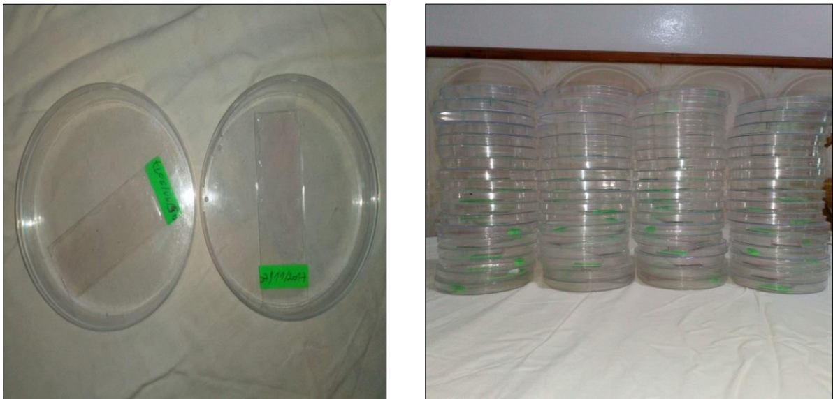
Figure 9. Photographie personnelle des lames enduites par la glycérine gélatinée.
