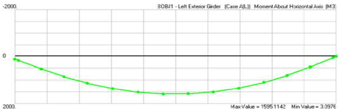
Fig III.20. Diagramme du moment de la poutre de rive due à A(L)
