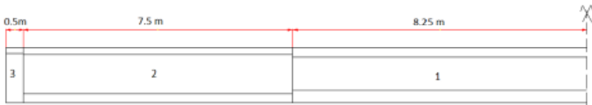
Fig. III.2. Coupe longitudinale de la demi-poutre
