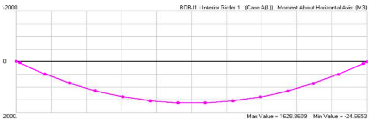
Fig.III.21. Diagramme du moment de la poutre intermédiaire 1 due à A(L)
