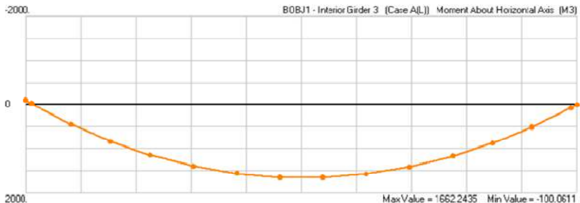
Fig.III.22. Diagramme du moment de la poutre intermédiaire 2 due à A(L)
